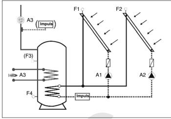
Control de una instalación de producción de ACS con energía solar con 2 zonas de captación (cada una con su propio circulador) y un depósito acumulador de doble serpentín.
