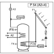
Control de una instalación para la producción de ACS mediante energía solar con depósito acumulador de doble serpentín y apoyo de caldera de gas o gasóleo. En esta instalación el valor del parámetro 54 ha de ser A2=4
