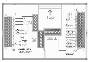
Conectar la fase en 2 y realizar los puentes 2-3 y 3-10 indicados en el esquema. Conectar el neutro en 1 y en la regleta N. Conectar borne 16 ó 19 a la regleta GND.
