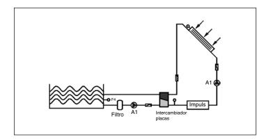
Control de una instalación para calentamiento de piscina mediante energía solar
