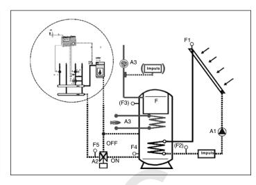
Control de una instalación de producción de calefacción y / o ACS mediante energía solar con depósitos acumuladores independientes para el precalentamiento solar y el apoyo de caldera.
