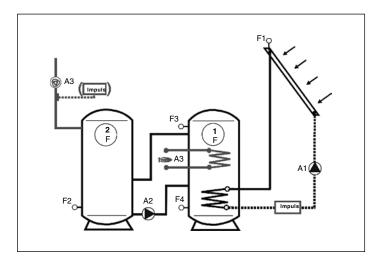
Control de una instalación de producción de ACS mediante energía solar con depósito acumulador de doble serpentín con apoyo de caldera (1) y depósito acumulador de sobreproducción (2).
