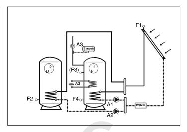
Control de una instalación de producción de ACS (1) y segundo acumulador para calefacción, calentamiento de piscina o ACS adicional (2) mediante energía solar, con distribución a cada depósito a través de dos circuladores. Se realiza también el control del apoyo de caldera en el depósito acumulador de ACS (1).
